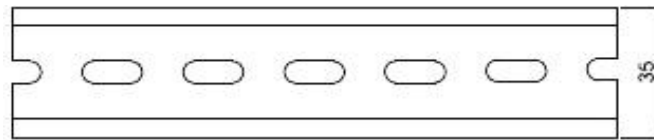
Install rail / 安装轨道: TS35/7.5 or TS35/15
