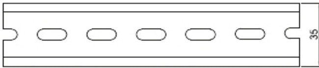
Install rail / 安装轨道: TS35/7.5 or TS35/15
