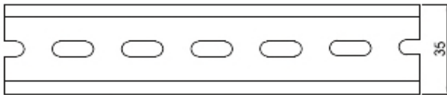
Install rail / 安装轨道: TS35/7.5 or TS35/15
