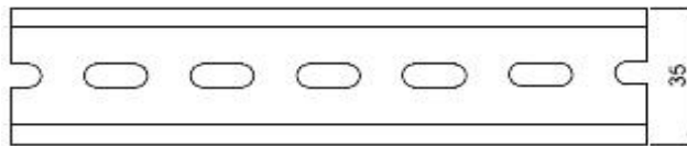
Install rail / 安装轨道: TS35/7.5 or TS35/15
